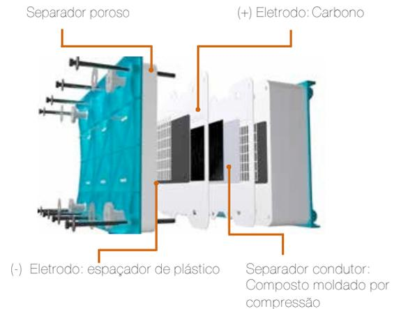
Ao contrário das baterias típicas que são empacotadas como células ou módulos fixos, uma bateria de fluxo permite que a energia (a taxa de fluxo de eletricidade) seja dissociada da capacidade (a quantidade total de energia detida). Como resultado, os usuários têm a flexibilidade de utilizar a bateria para diversas funções.
